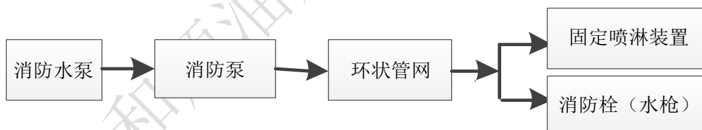
图 4.2.1-2 本项目消防给水系统流程图
